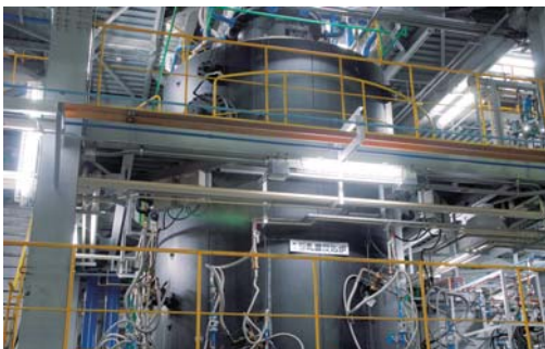
廃棄物を熔融する高温反応炉
