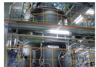
廃棄物を溶融する高温反応炉
