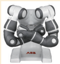
安全柵を必要とせず人と並んで作業ができるABB製「Yumi®」 (画像:ABB株式会社 提供)
