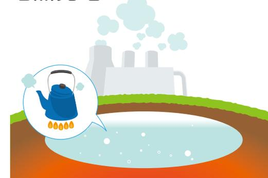
地下のマグマで沸騰した地下水の熱い蒸気で、発電機を動かします。天候の影響を受ける太陽光発電や風力発電と異なり、安定した電力を供給できることがメリットの一つです。一方で、地下深くまで井戸を掘削する必要があるため、多くの時間と費用がかかります。最近では、発電に使用した蒸気を冷やして水として地下に戻すなど、資源を枯渇させない技術も開発されています。
