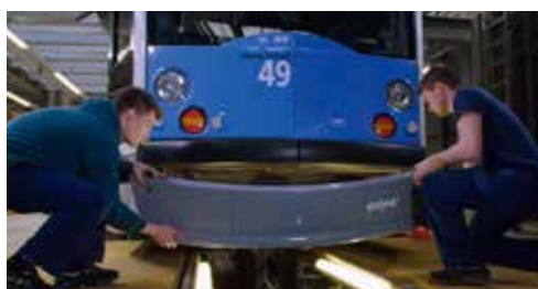
鉄道車両のバンパー部品。3Dプリンタで出力できるように、3パーツで構成。斜め衝突のケースでは、1パーツの交換で対応可能になりました。
