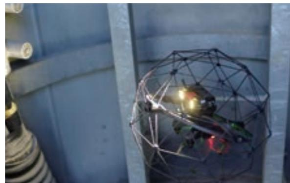
8月、従来のドローンでは飛行が難しい屋内でも使用できる球体ドローン「ELIOS」のレンタルを開始しました。「ELIOS」は、プラントの内部や煙突、大型施設の天井部、遊園地のアトラクションなど、屋内の高所や狭小空間の点検に使用することができます。必要なタイミングで必要な期間だけご利用いただけるレンタルを通して、安全で迅速な点検業務をサポートします。また、ドローンを用いて点検箇所の撮影を受託する撮影サービスや、ドローンの操縦技術の習得をサポートするトレーニングスクールなど、関連するさまざまなサービスを拡充することで、企業のドローン活用を支援していきます。
