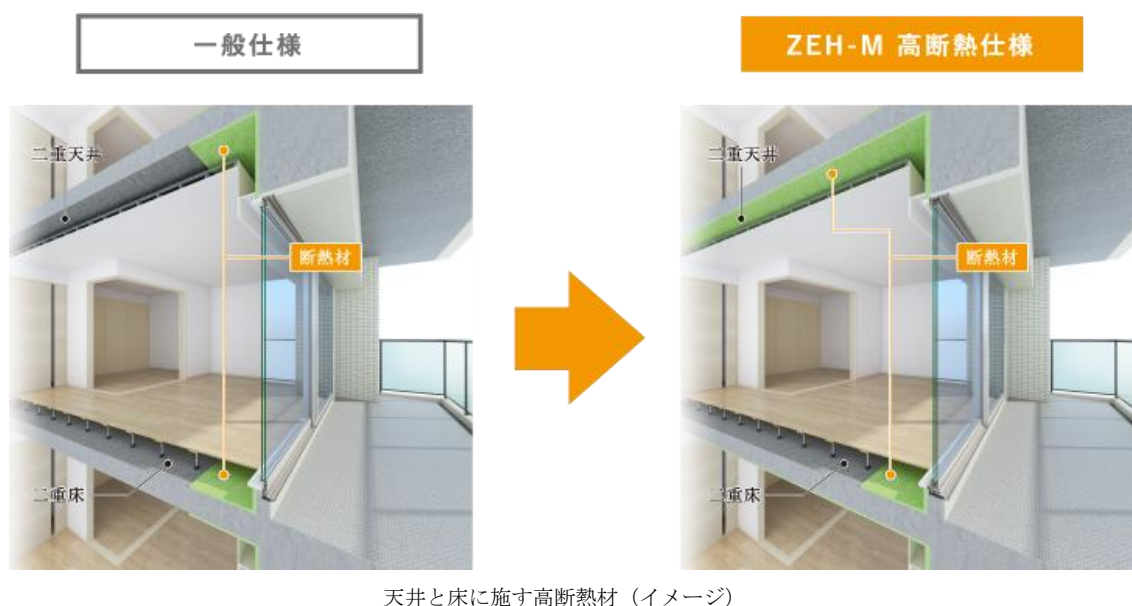
天井と床に施す高断熱材（イメージ）
