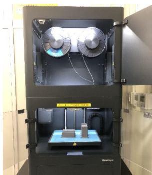
フィラメントをセットした「Metal X」の内部
