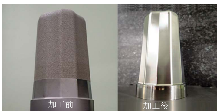
(写真上：3D 冷却水管金型)
