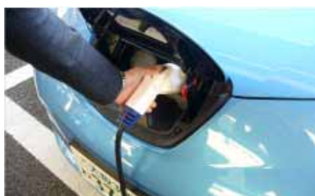
充電ケーブルを充電口にさす。
