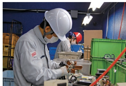
OA機器の解体・分別作業
